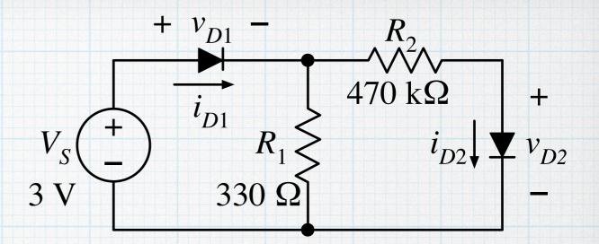
$$V_S - v_{D1} - v_{R1} = 0$$
